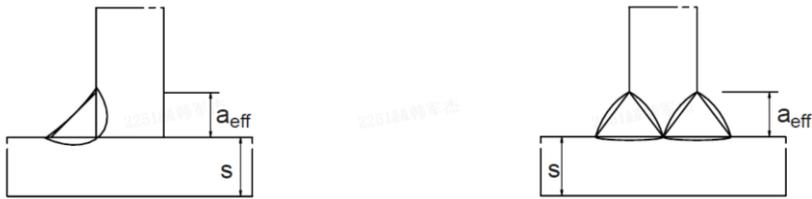
图 2 焊脚尺寸
